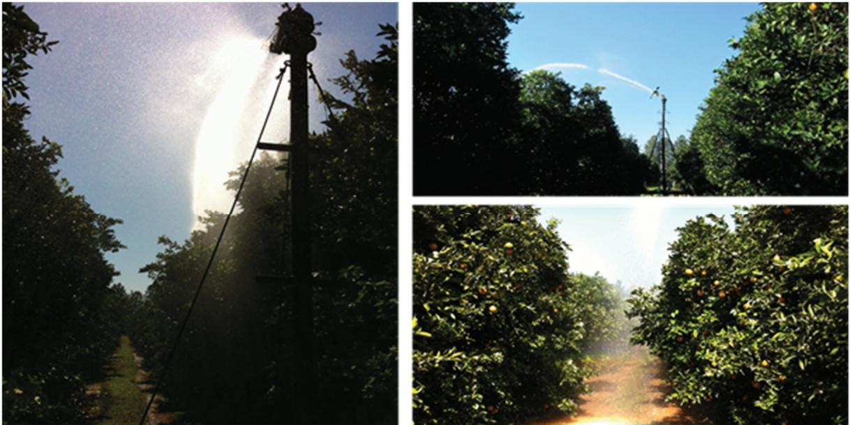
**Figura 5.** Equipamento de irrigação por aspersão (tipo canhão autopropelido) utilizado para simular chuva no campo experimental.
