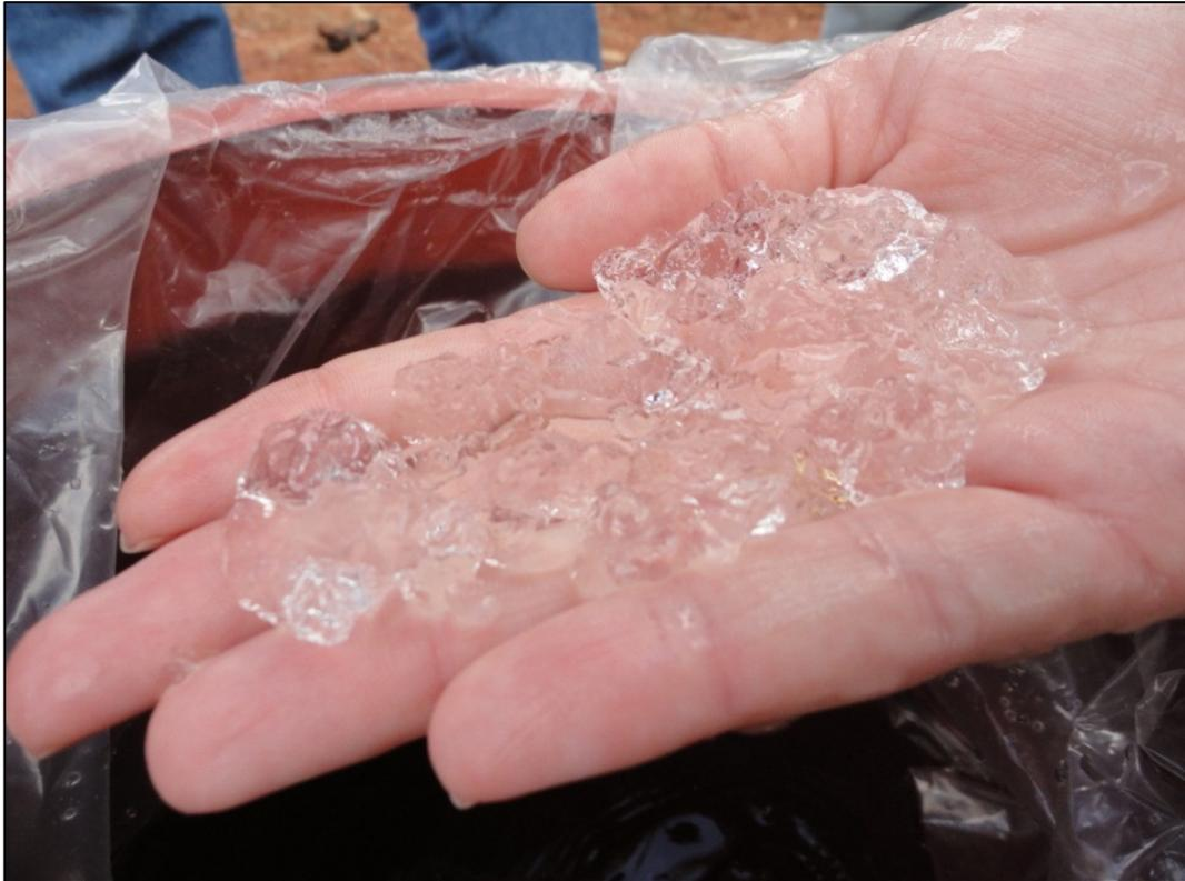
**Figura 4.** Consistência do Gel após a hidratação por um período de 30 min.
