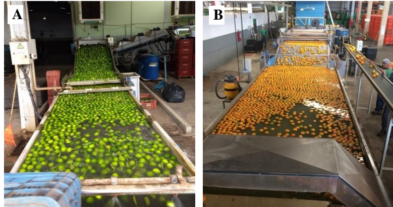
Figura 3. Balsa de imersão para a higienização de frutos de citros em pós-colheita na unidade de consolidação. Frutos de lima ácida ‘Tahiti’ (A) e frutos de laranja doce (B).
