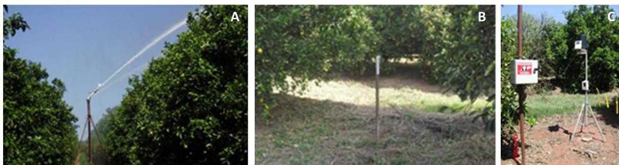
**Figura 1** – Detalhe do equipamento de irrigação (tipo canhão autopropelido) (A), dos pluviômetros distribuídos na área (B) e da estação meteorológica Davis Vantage Pro 2 (C).
