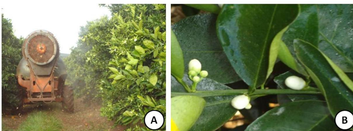
**Figura 2** – Turbo-pulverizador da marca Jacto 4000 modelo Valencia utilizado nas pulverizações (A), cobertura da calda fungicida sobre os tecidos de laranja doce nas pulverizações para o controle da podridão floral na área experimental em Iaras, SP (B).
