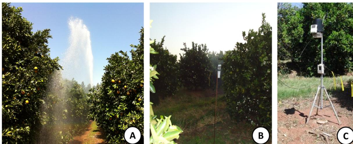
**Figura 3** – Equipamento de irrigação auto-propelido (A), pluviômetro para registro do volume de chuva (B) e estação meteorológica utilizada no estudo(C).
