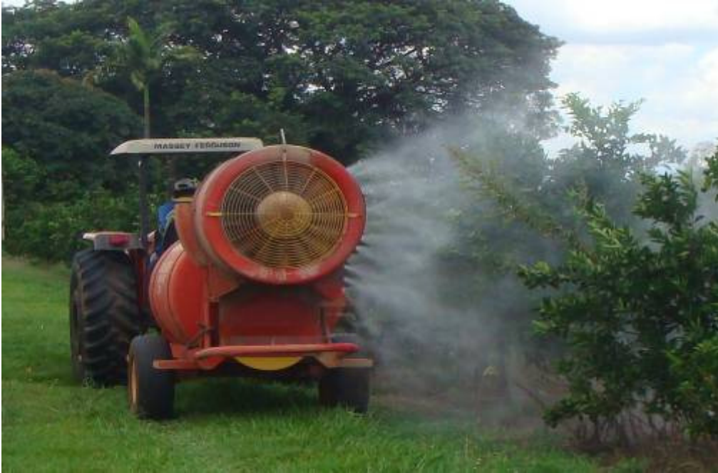
Figura 4. Turbopulverizador FMC 2000 acoplado ao trator utilizado para efetuar as pulverizações foliares de inseticidas de contato. Foto de Renato B. Bassanezi.
