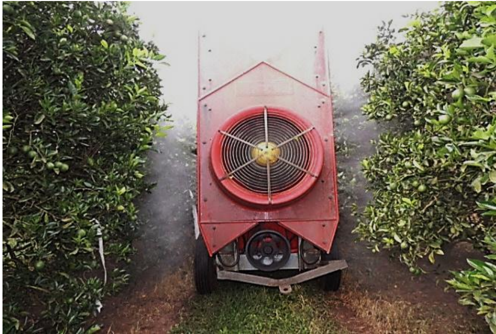
Figura 4. Turbo-pulverizador da marca Natali ® , modelo Alfa 4000, tracionado por um trator MF 275 Advanced, durante aplicação de fungicidas em experimento de controle da pinta preta dos citros, em Mogi Guaçu/SP, em março de 2016.
