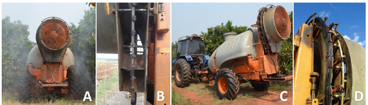
Figura 4. Pulverizador Arbus Jacto Valencia 4000 L (A) com ramal especial de pontas padrão convencional da fazenda (B) e pulverizador Arbus Jacto Valencia 4000 L (C) adaptado com o ramal eletrostático SPE com pontas especiais e cabeamento para geração de carga (D).
