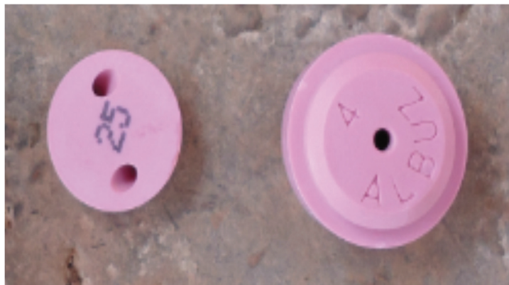
Figura 10. Conjunto de difusor e ponta de pulverização Albus AD 4 DC 25.
