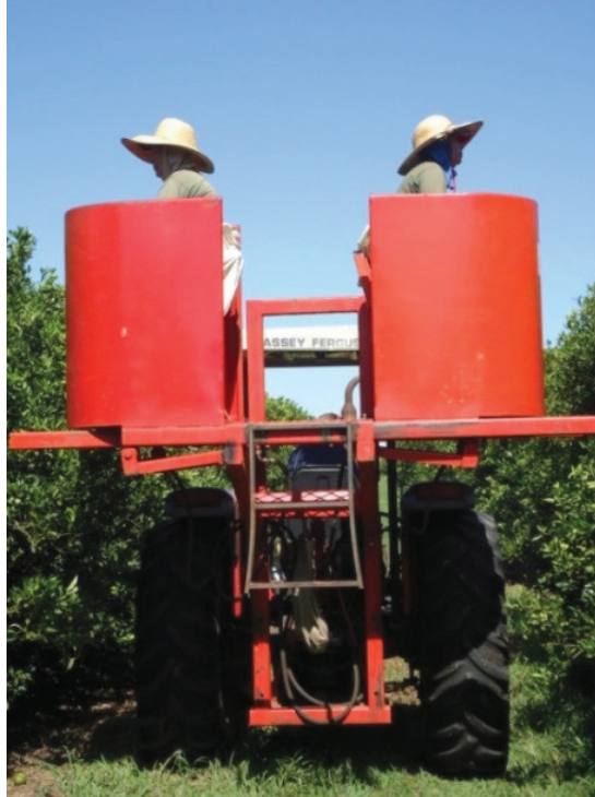
Figura 4. Inspeção para detecção de plantas com sintomas de HLB em plataforma para dois inspetores acoplada a um trator.
