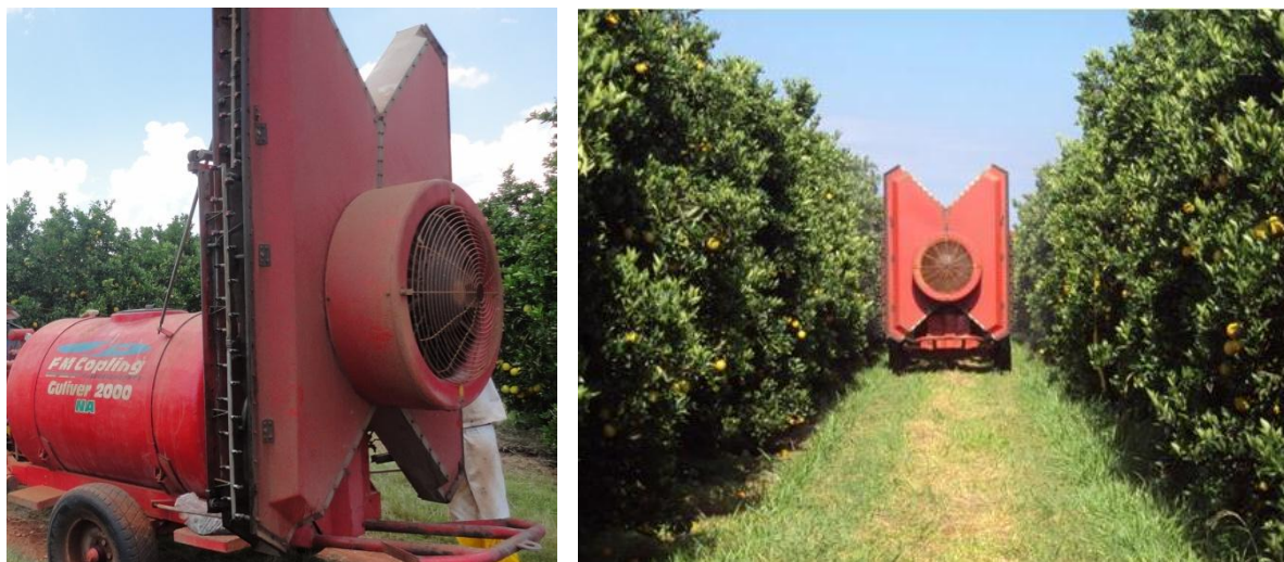
Figura 2 – Turbo pulverizador FMCoppling utilizado no experimento de controle da mancha preta dos citros em pomar ‘Valencia’ em Mogi Guaçu, SP.
