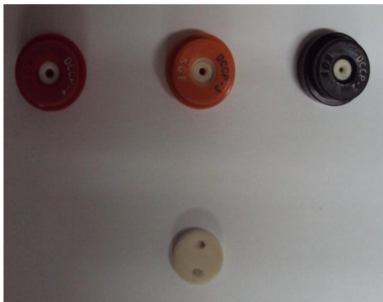
Figura 4. Modelo de pontas de pulverizações DCCP, DCCP 3 e DCCP 4 (acima) e difusor 25 (abaixo) utilizados na aplicação dos tratamentos.
